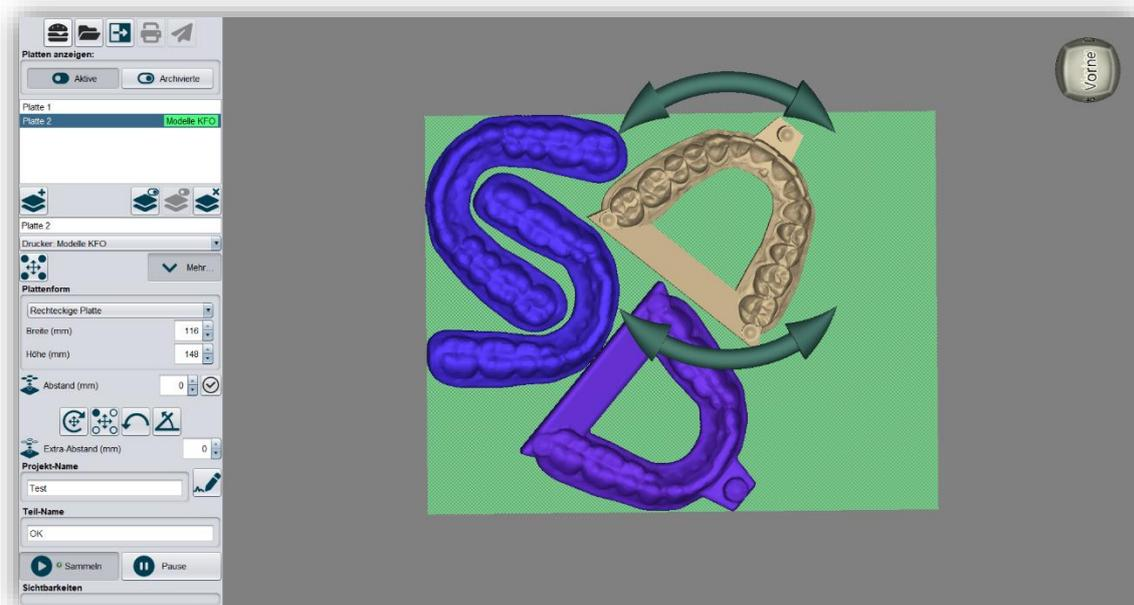
**Bild 16:** Ansicht der geladenen Meshes auf der Druckerplattform.
